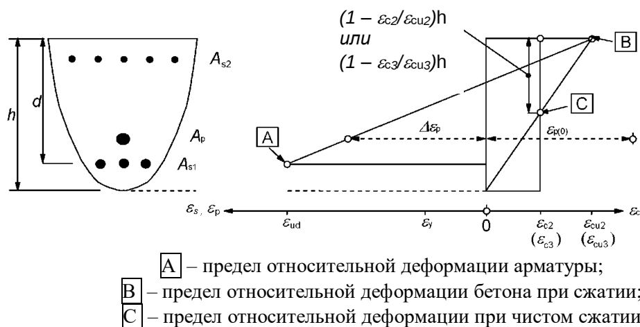
Рисунок 6.1 – Возможное распределение относительных деформаций в критическом предельном состоянии
