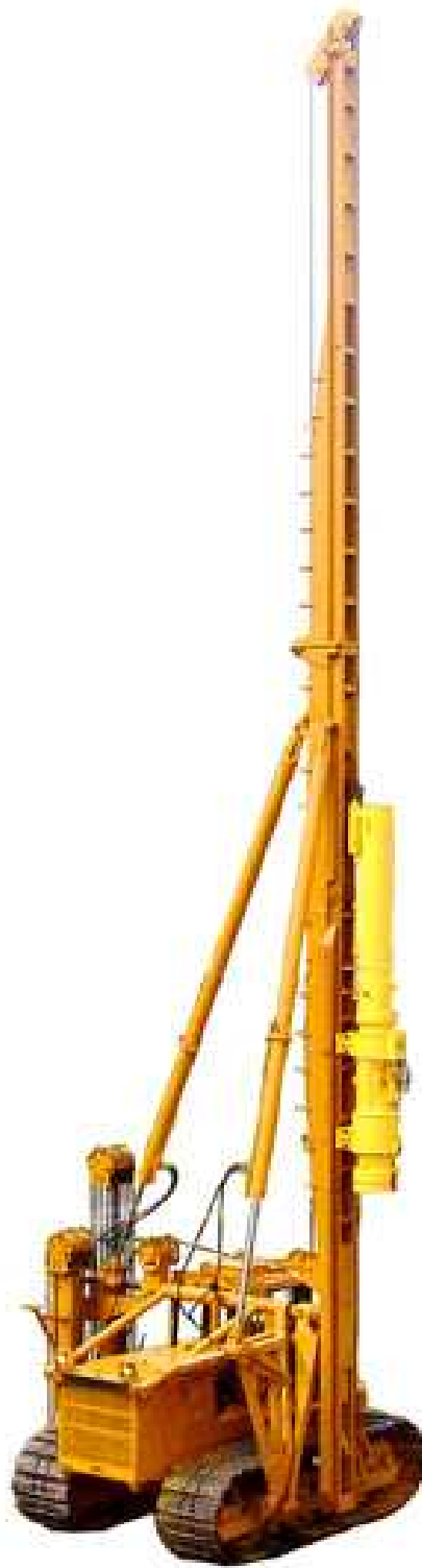
Рисунок – 4 – Сваебойная установка типа «СП-49»
