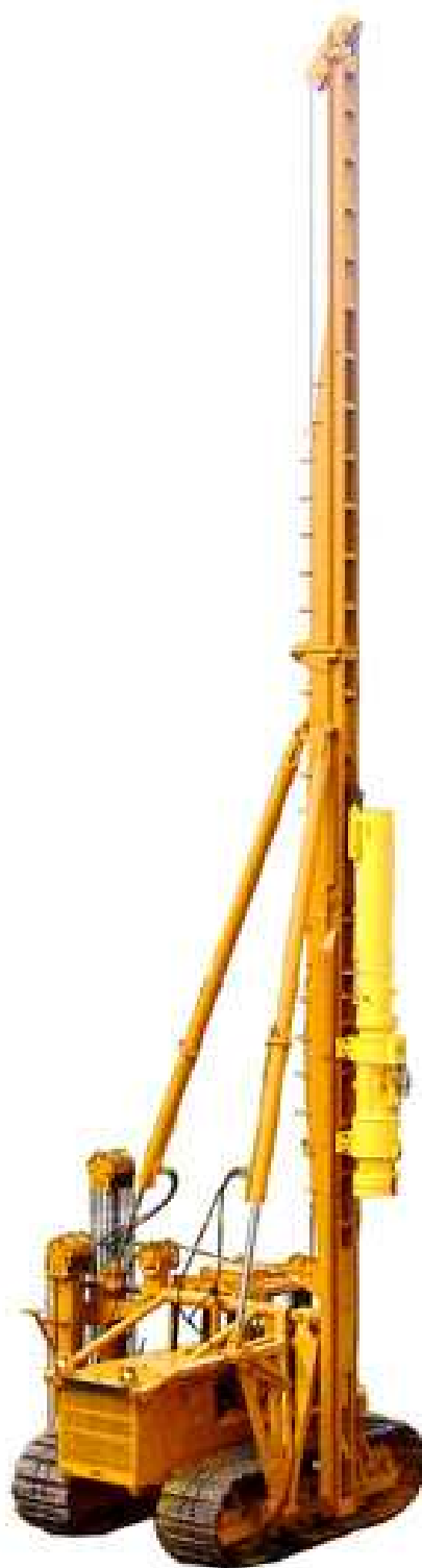
4-сурет – «СП-49» типті қада қағатын қондырғы
