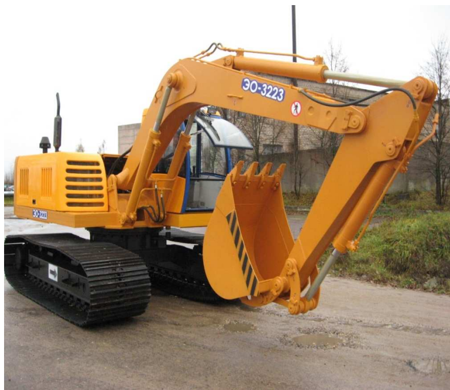
1-сурет-Шынжыр табанды жүрістегі кері күрегі бар бір шөмішті гидравликалық экскаватор
