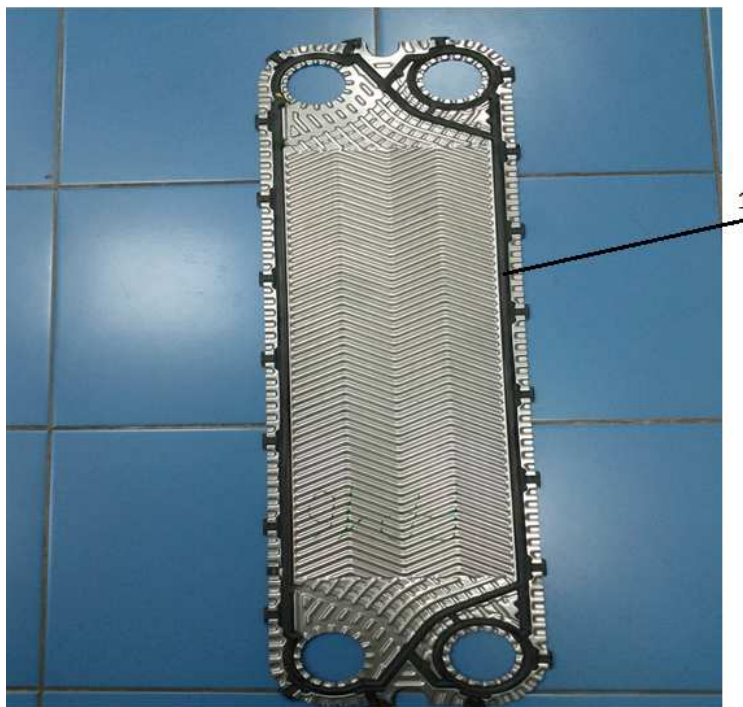
4-сурет – Төсемі бар пластина 1-тіркегіші бар тығыздау төсемі
