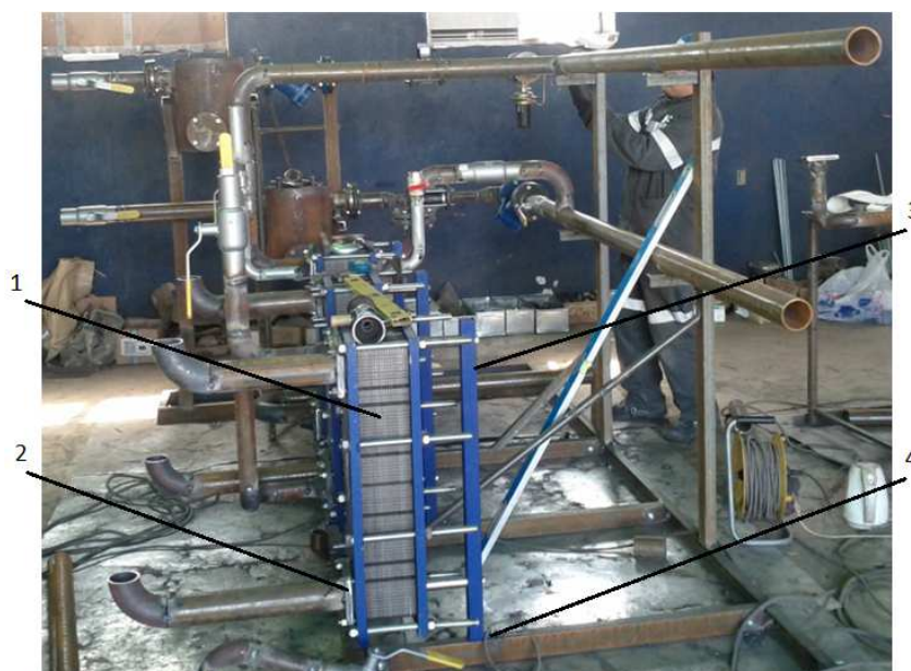
11-сурет – Пластина тәрізді жылу алмастырғыштарды орап байлау процесінің басталуы
