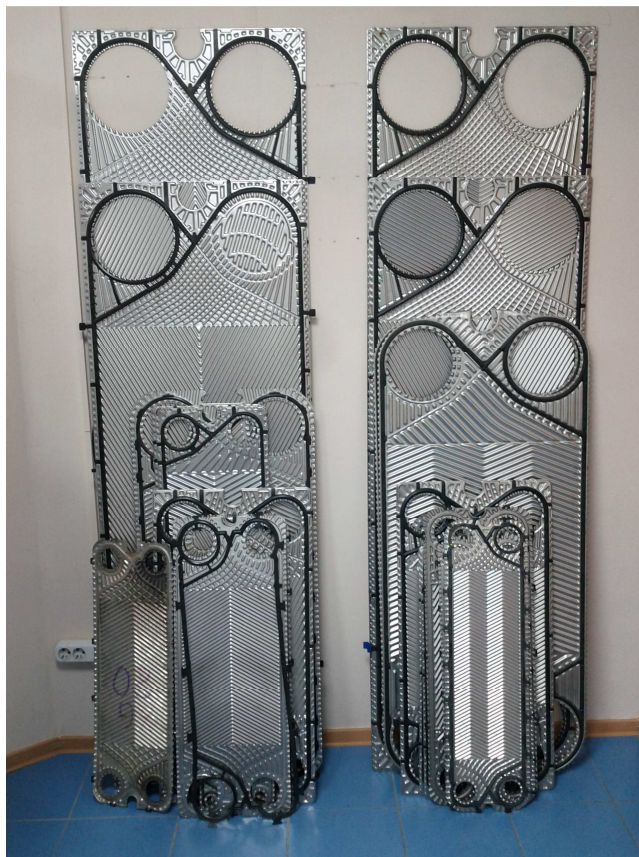
Рисунок 3 - Пластины теплообмена различных размеров с прокладкой уплотнения
