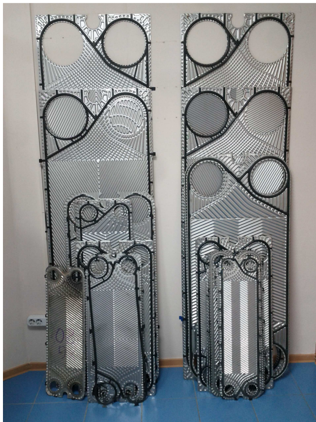
3-сурет - Тығыздау төсемі бар әртүрлі өлшемдердегі жылу алмасу пластиналары
