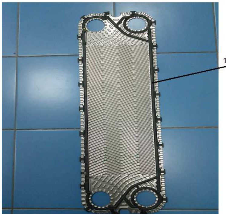
Рисунок 4 - Пластина с прокладкой 1-прокладка уплотнения с фиксатором
