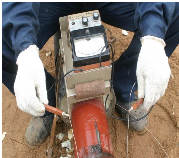
Рисунок 27 – Операция измерения сопротивления петли сигнальных проводов
