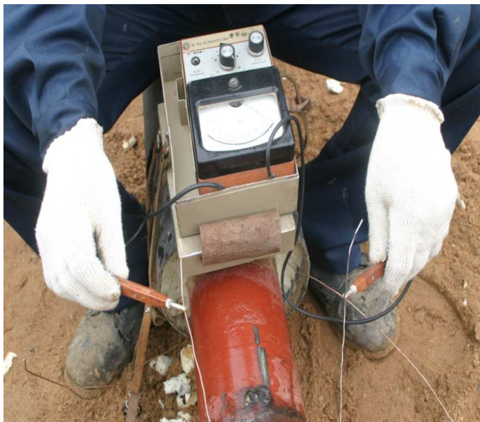
27-сурет – Дабылдық өткізгіштер ілгегі қарсылығын өлшеу операциясы
