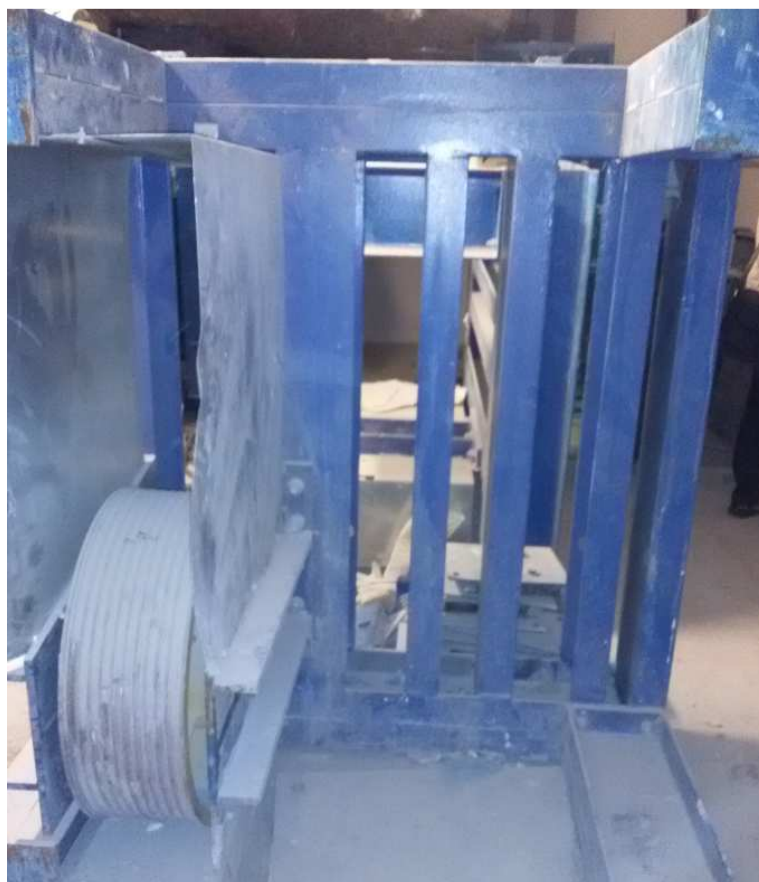
49-сурет – Бұру блогы бар лифт шығырының тірек рамасы
