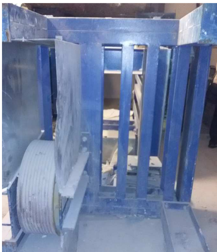
Рисунок 49 – Опорная рама лифтовой лебедки с отводным блоком
