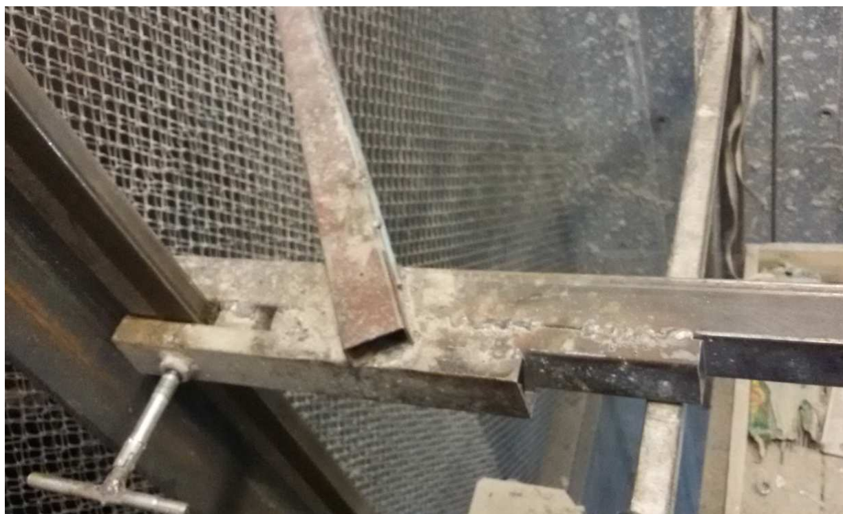
Рисунок 34 – Кондуктор для установки кронштейнов крепления направляющих
