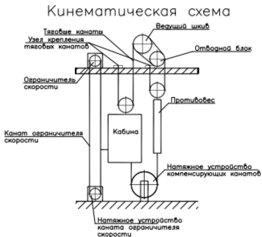
Рисунок 54 – Кинематическая схема полиспастной протяжки канатов
