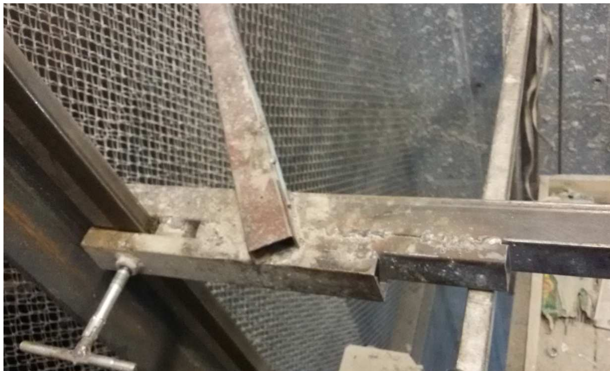
34-сурет – Бағыттағыштарды бекіту кронштейндерін орнатуға арналған кондуктор
