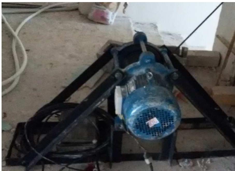
Рисунок 45 – Монтажная лебедка для монтажа лифтовой лебедки
