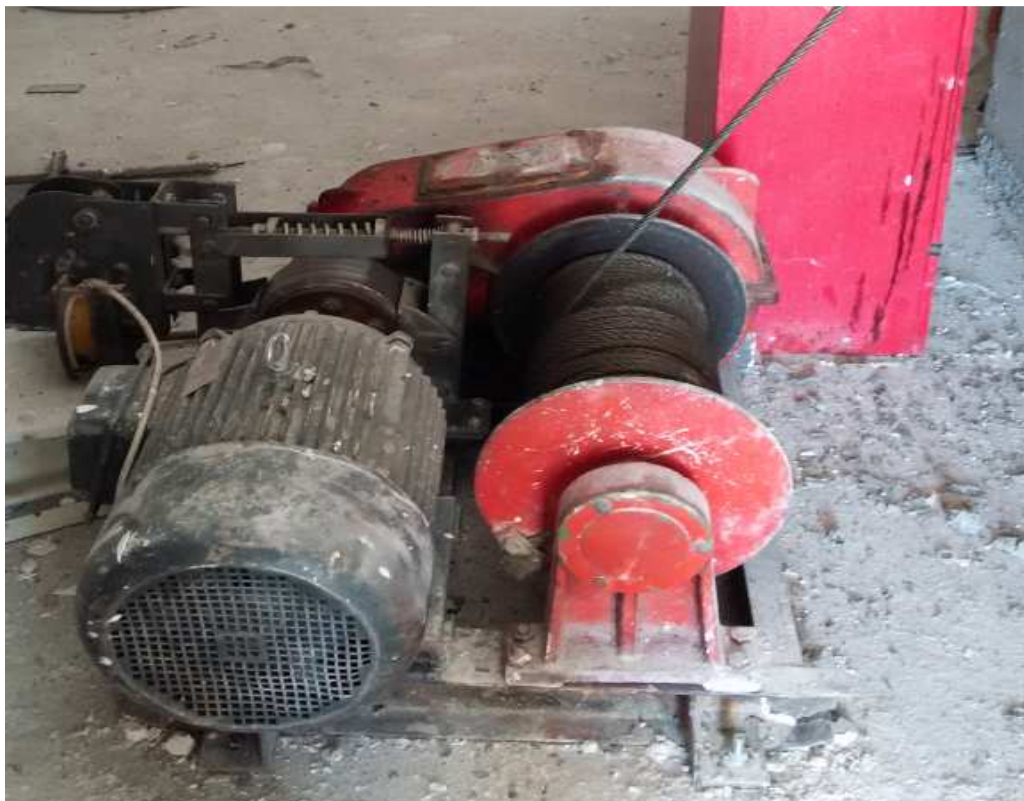
Рисунок 46 – Монтажная лебедка для монтажа лифтовой лебедки
