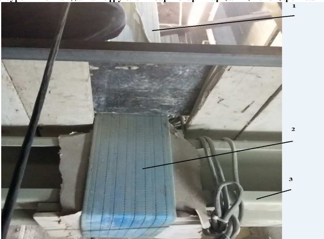
28-сурет – Монталдалған бұру блогы бар жоғарғы арқалық және қарсы салмақ
