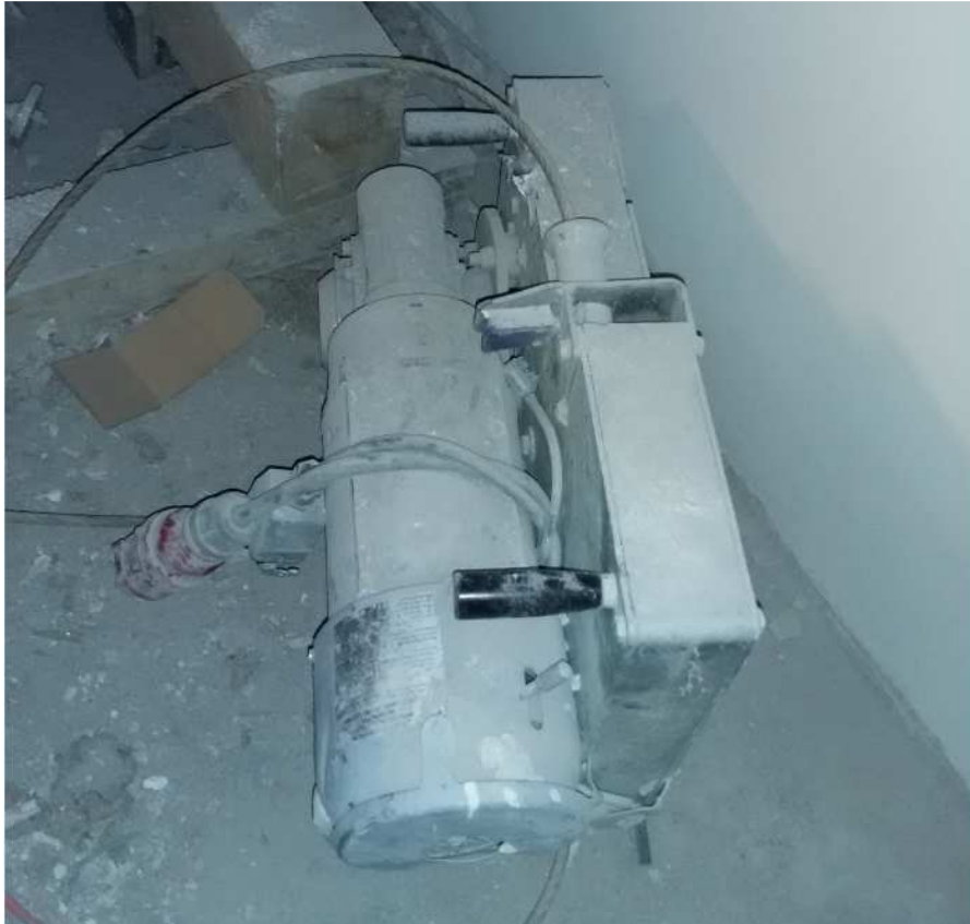
3-сурет – Жүк көтергіштігі жоғары өтпелі монтаждау шығыры және қосымша монтаждау шығыры
