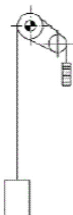
Рисунок 42 - Канатная система с верхним расположением лебедки, привод с двойным обхватом, кратность канатной подвески 1.
