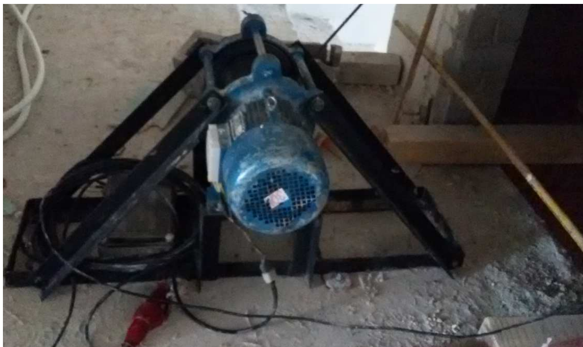
Рисунок 9 – Монтажная лебедка при отсутствии машинного помещения
