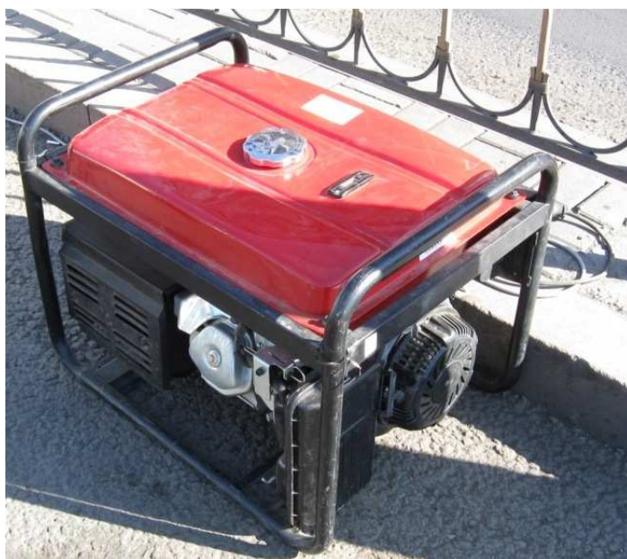
Рисунок 3 – Общий вид дизельного генератора мощностью 5 кВт
