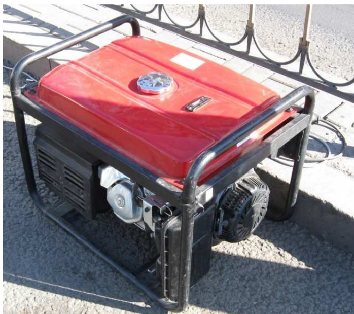
3-сурет – Қуаты 5 кВт дизелді генератордың жалпы түрі
