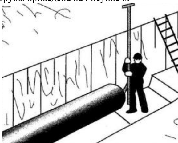
Рисунок 6 – Выверка положения трубы
