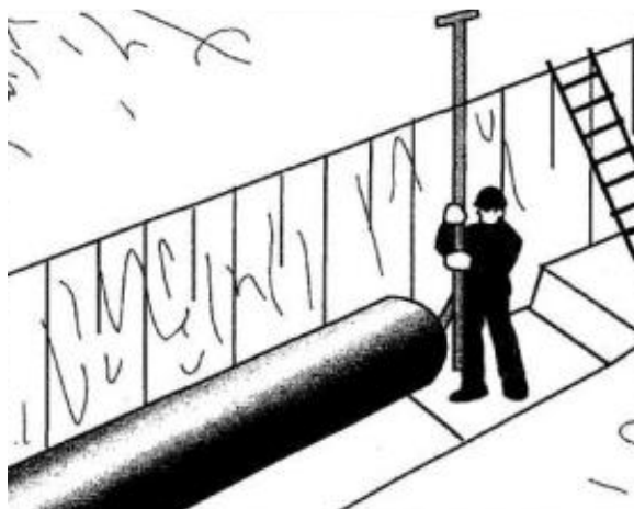
Рисунок 6 – Выверка положения трубы
