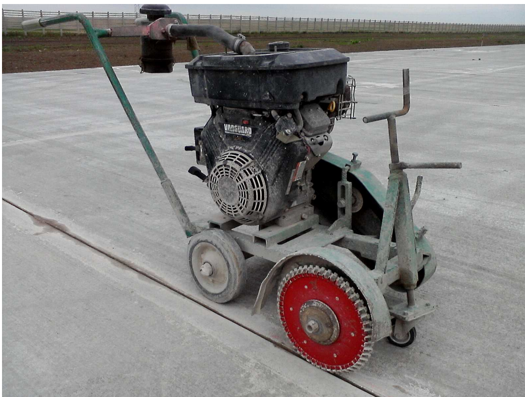
Рисунок 11 – Машина для снятия фаски кромок шва
