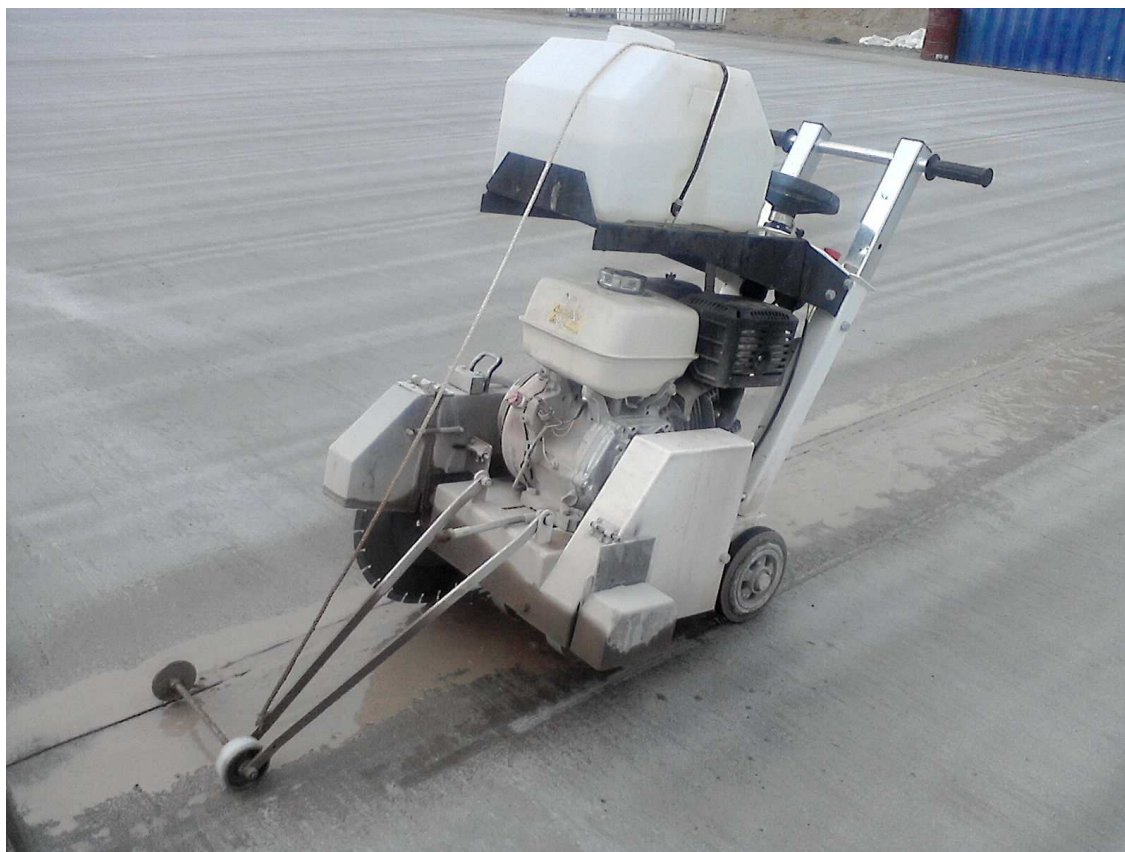
Рисунок 5 – Общий вид нарезчика поперечных швов
