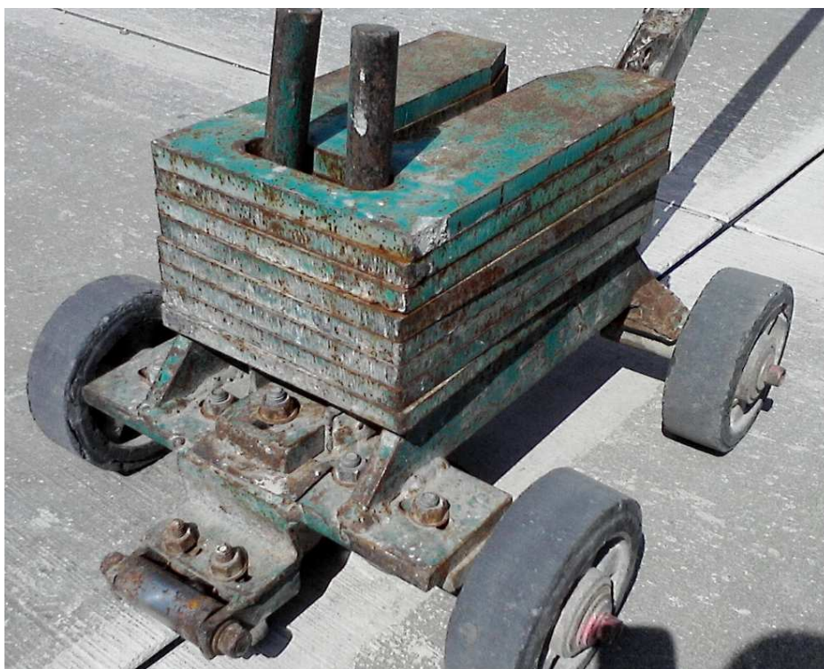
Рисунок 18 – Машинка по закладке уплотнительного профиля в шов
