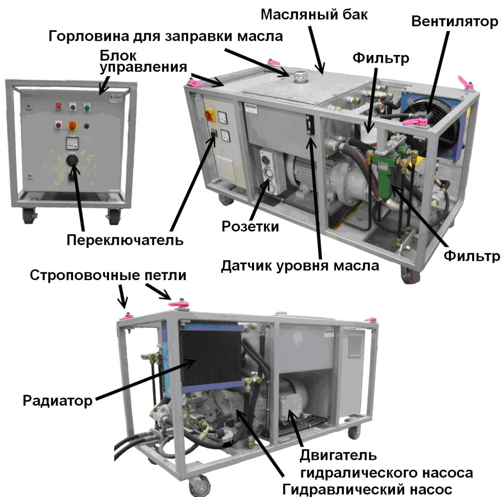
Рисунок 8 - Общий вид гидравлической станции (силовой установки)
