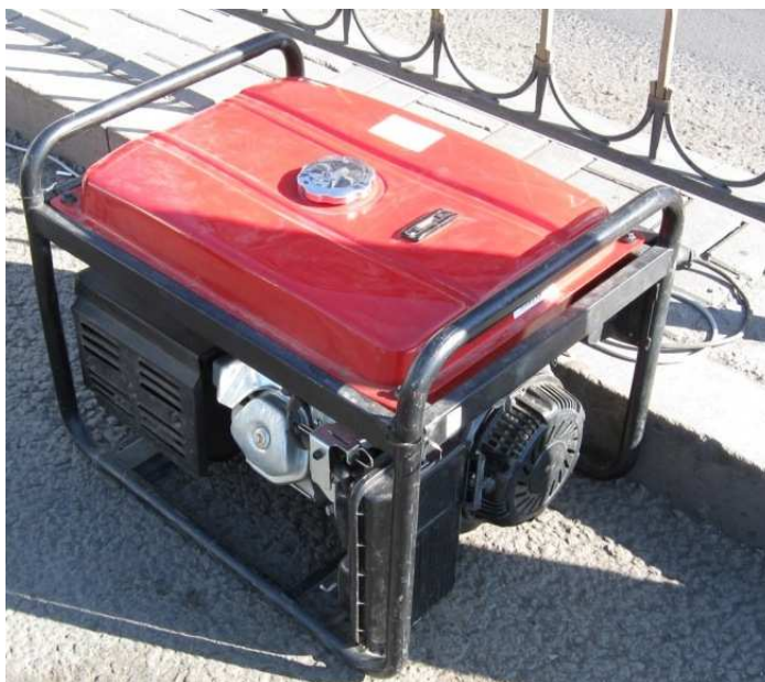
Рисунок 10 - Общий вид дизельного генератора мощностью 5 кВт
