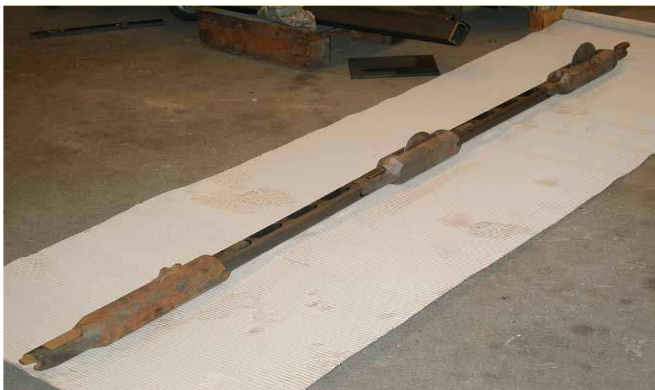
Рисунок 9 – Модификации наборного режущего ножа
