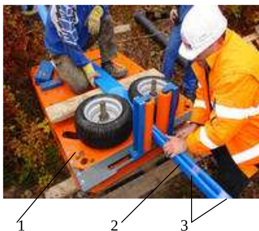
1 – машина для складывания рукава; 2 – сложенный рукав; 3 – скрутки из клейкой ленты
