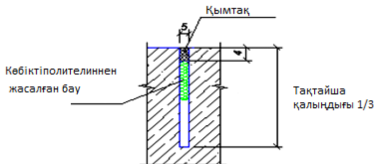
7-сурет - Температуралық-шөгінді жіктің үлгілік конструкциясы
