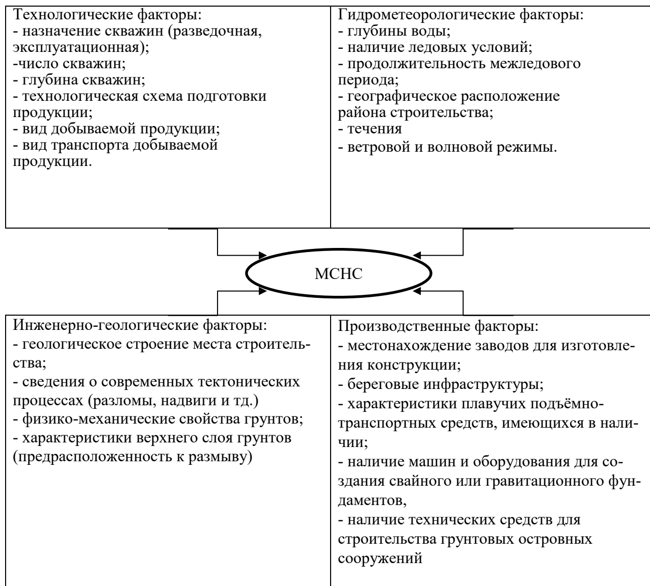
Рисунок Б.1 – Основные факторы, определяющие особенности конструкции морского нефтегазового гидротехнического сооружения (МСНС)
