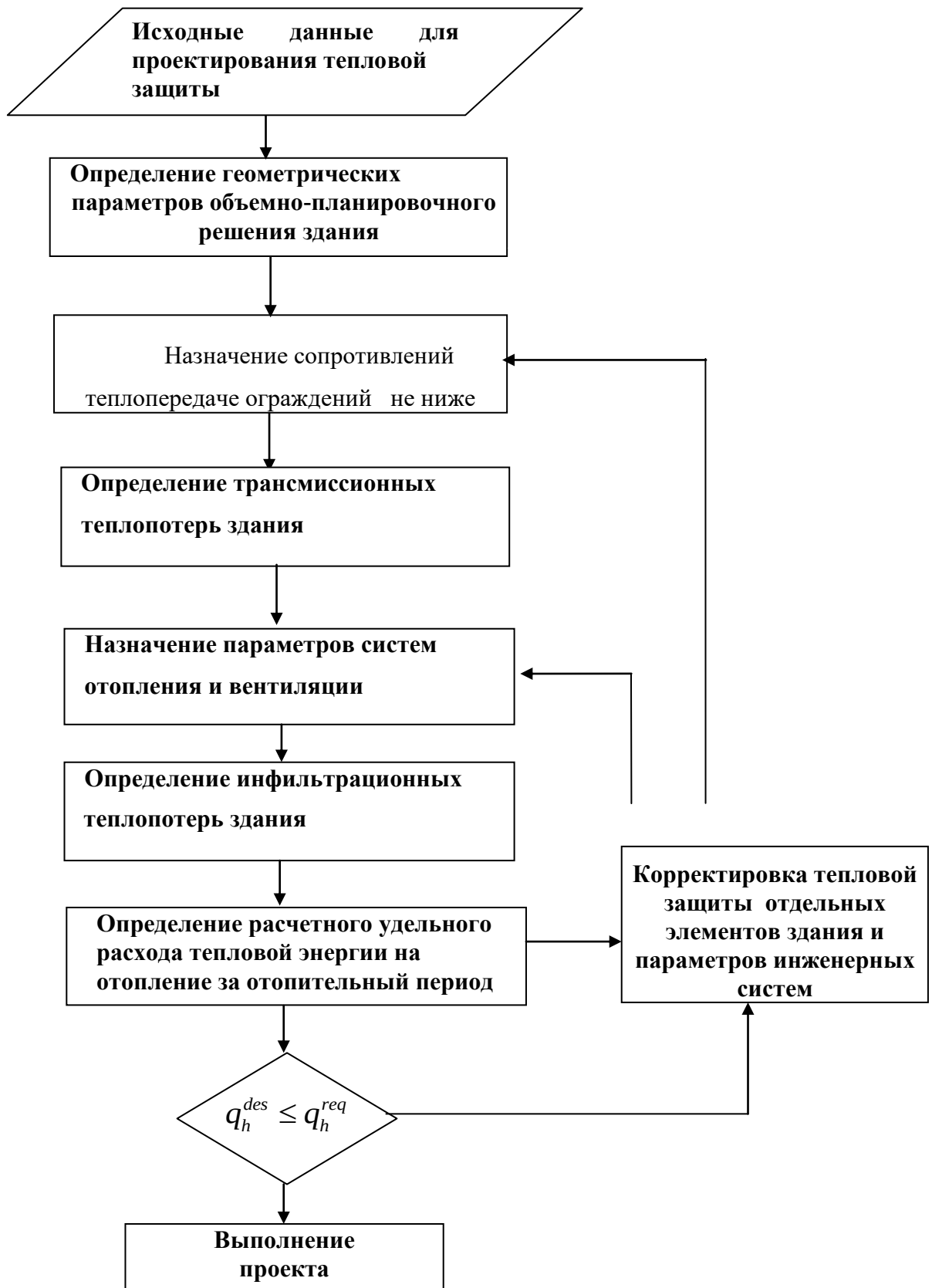
Рисунок 33 – Рекомендуемый алгоритм проектирования тепловой защиты
