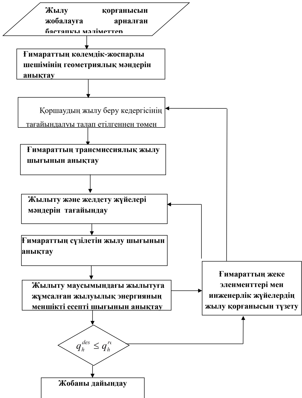
33-сурет – Жылу қорғанысын жобалаудың ұсынылатын алгоритмі
