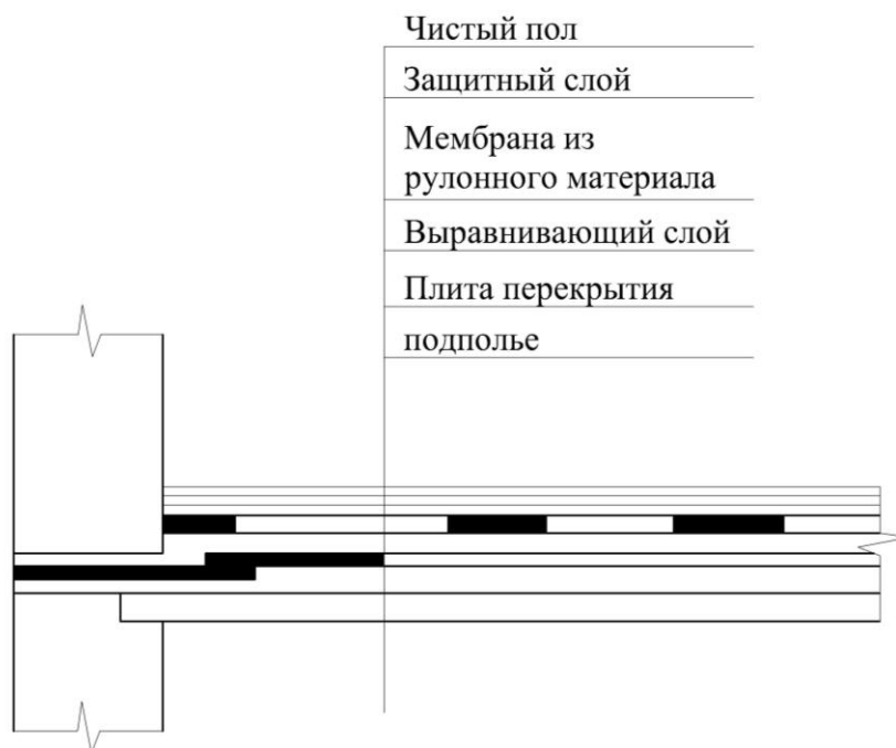
Рисунок В.3 - Радиоизолирующая мембрана
