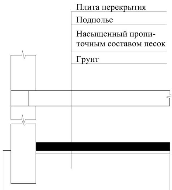
Рисунок В.1 - Пропиточная противорадоновая изоляция грунтового пола подполья
