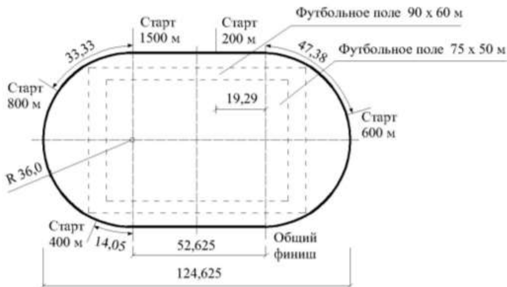
Рисунок В.2 - План контура внутренней бровки легкоатлетической дорожки длиной 333,33 м для бега по кругу с одноцентровыми поворотами, описанными по радиусу 36 м
