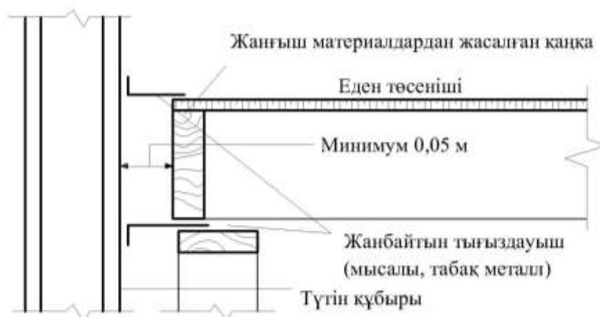
11 - сурет - Түтін құбырынан құрылыс конструкцияларына дейінгі қашықтық
