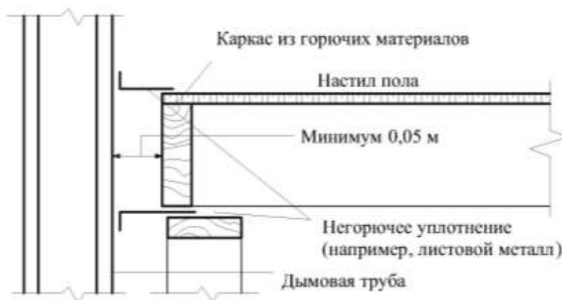
Рисунок 11 – Расстояние от дымовой трубы до строительных конструкций
