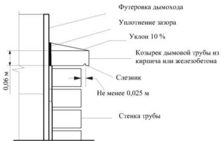
Рисунок 10 – Оголовок дымовой трубы
