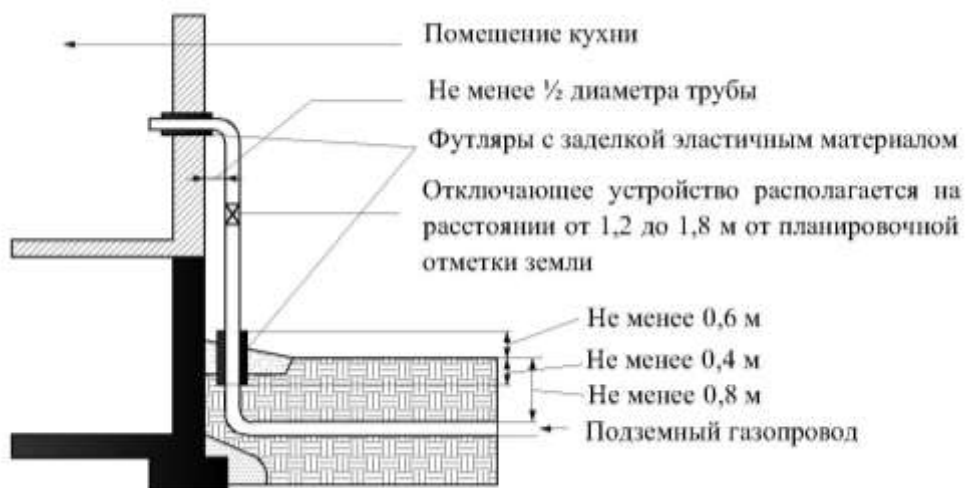
Рисунок 13 – Газовый ввод
