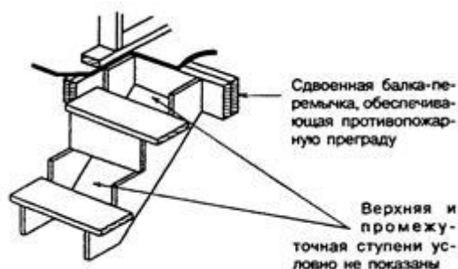
Рисунок 12.2 - Противопожарная преграда в лестничном проеме
