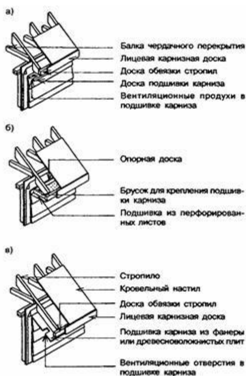
Рисунок 8.5 - Устройство карнизов
