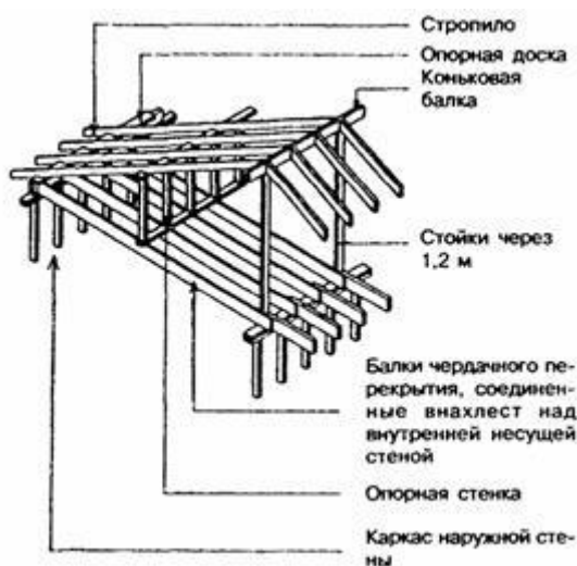
Рисунок 8.2 - Каркас скатной крыши с уклоном менее 1:3 с промежуточной опорой в виде опорной стенки
