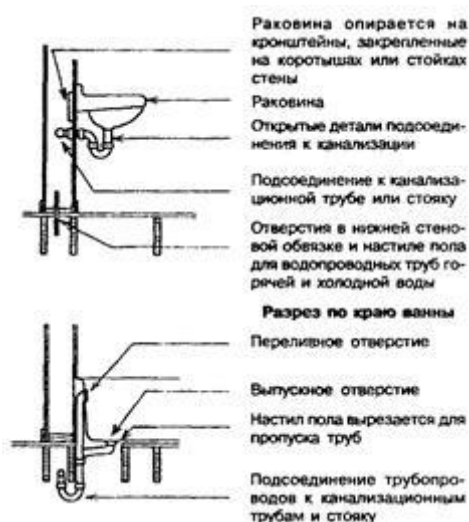
Рисунок 13.6 - Детали установки умывальника и ванны
