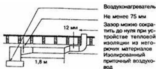
Рисунок 13.1 - Воздуховоды воздушного отопления
