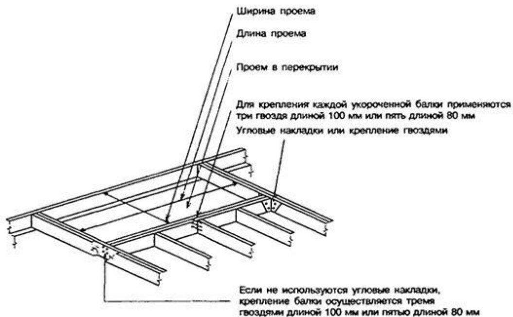
Рисунок 6.12 - Устройство проемов в перекрытии
