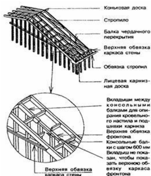
Рисунок 8.7 - Карниз над фронтоном с выносом более 300 мм
