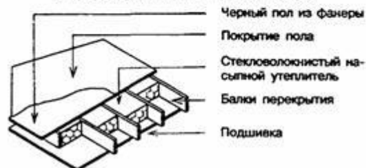
Рисунок 9.3 - Утепление перекрытий над неотапливаемыми помещениями
