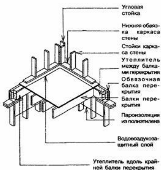
Рисунок 9.2 - Укладка утеплителя в местах расположения ниже обвязочных и крайних балок перекрытия
