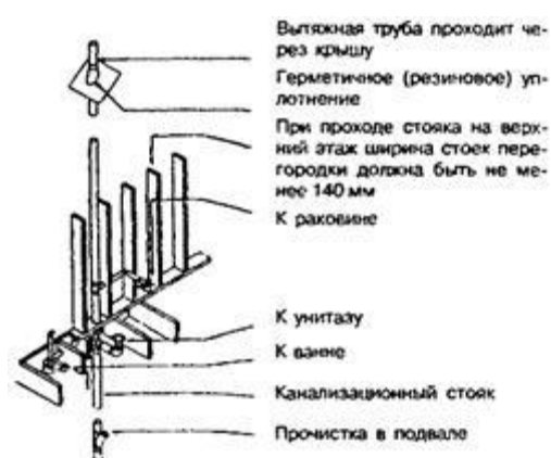
Рисунок 13.8 - Прокладка канализационных труб в каркасе дома
