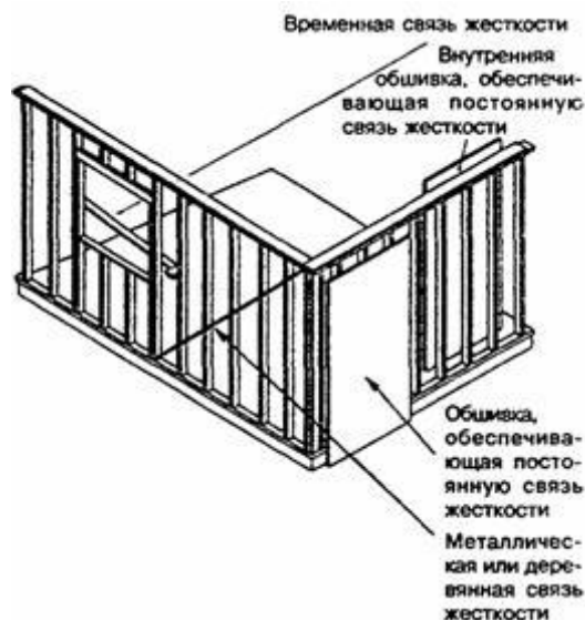
Рисунок 7.1 - Каркас стены
