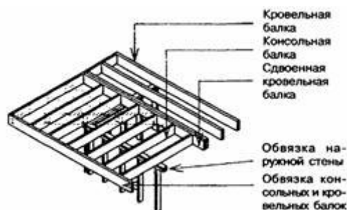
Рисунок 8.4 - Каркас плоской крыши
