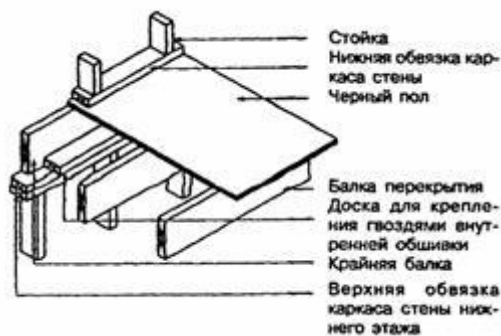
Рисунок 7.4 - Деталь установки доски для крепления внутренней обшивки
