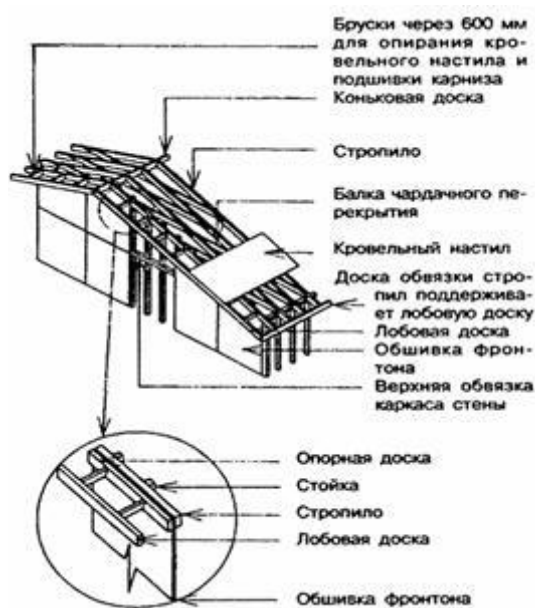
Рисунок 8.6 - Карниз над фронтоном с выносом 300 мм и менее
