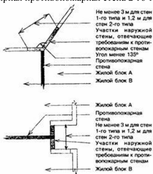
Рисунок 7.6 - Межквартирная противопожарная стена 2-го типа каркасной конструкции
