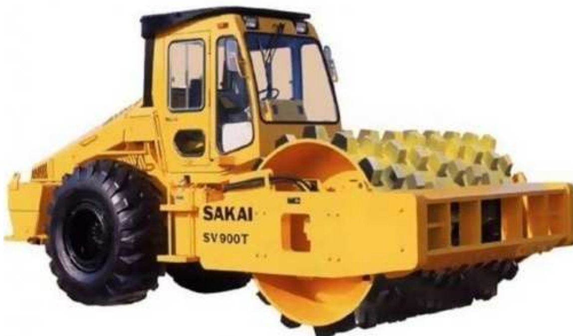
Рисунок 3 - Общий вид катка с кулачковым вальцом
