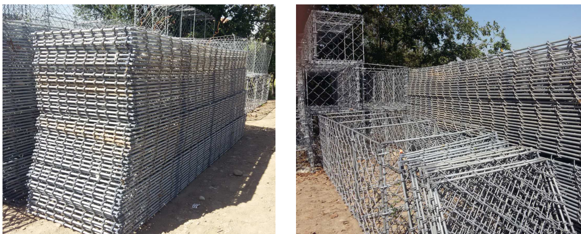
Рисунок 5 – Общий вид складирования готовых каркасов и габионных рам
