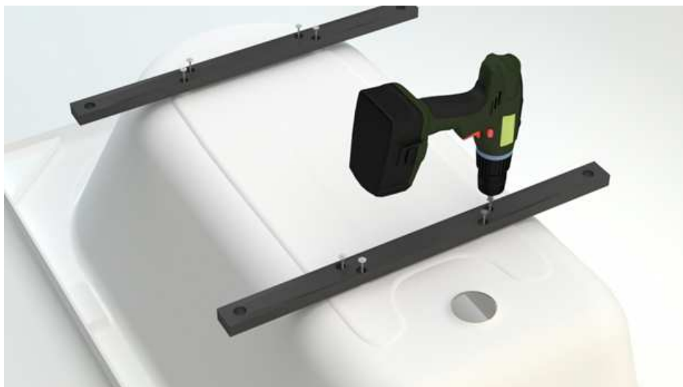
Рисунок 26 – Схема крепления несущего профиля каркаса на дне ванны
