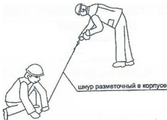
Рисунок 3 - Схема выполнения предварительной разметки проезжей части
