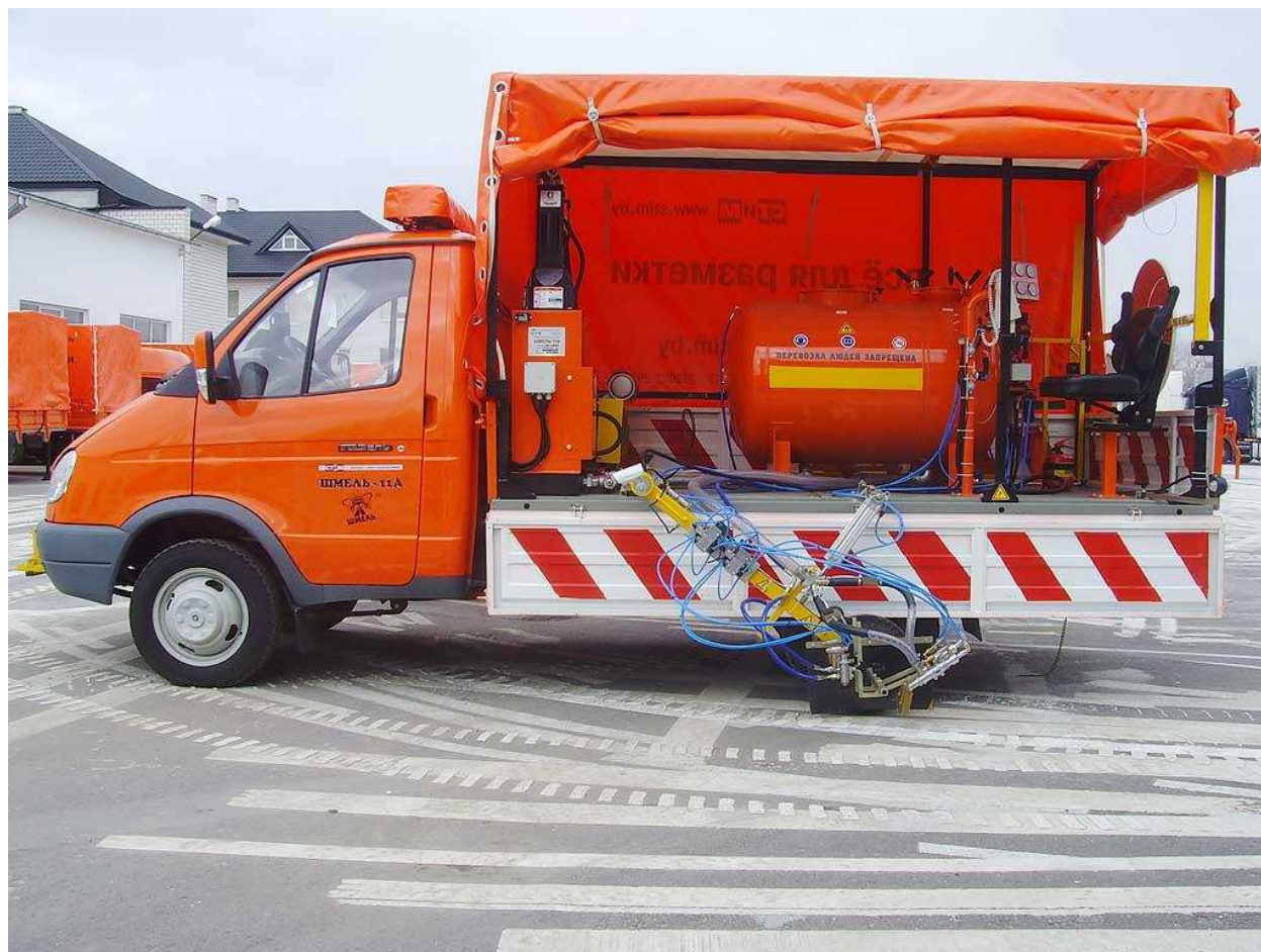
Рисунок 2 – Общий вид машины дорожной разметки типа «Шмель 11А»
