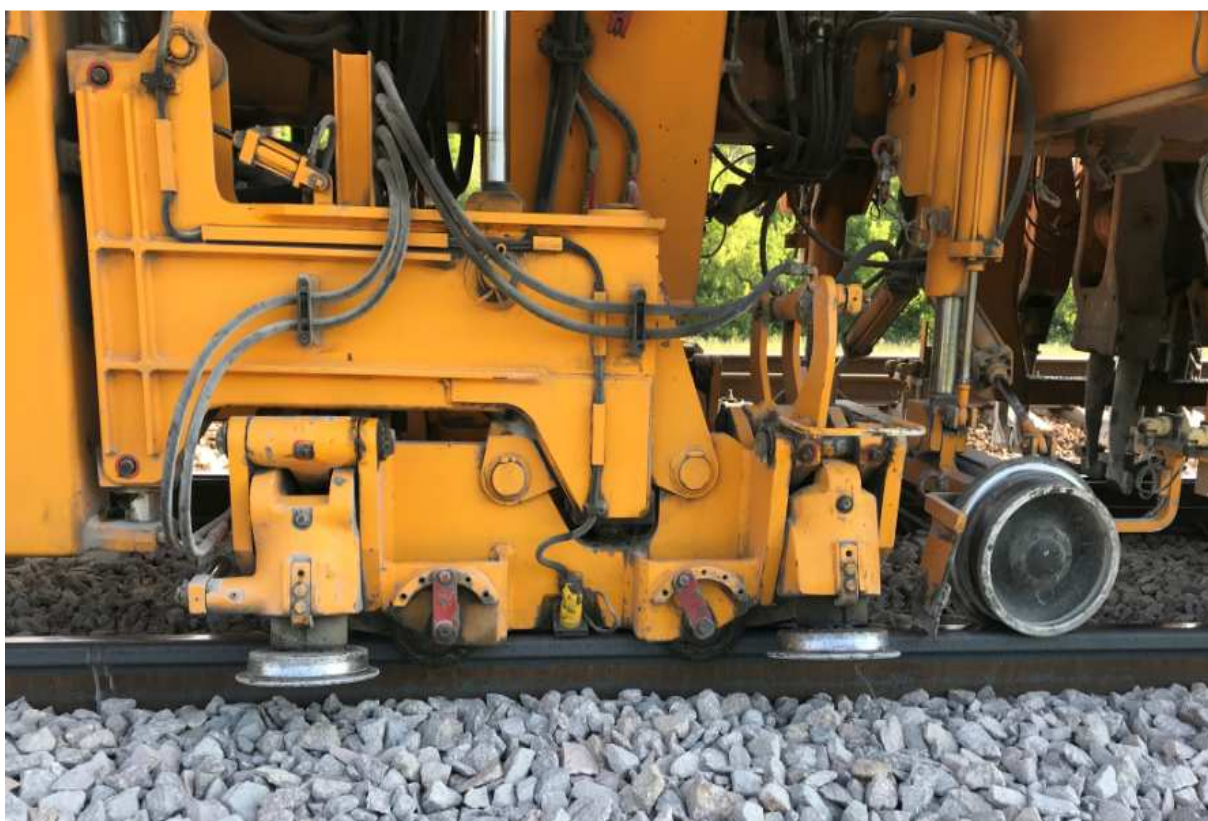
Рисунок 3 - Общий вид рабочих органов выправочно-подбивочно-рихтовочной машины «Duomatic»
