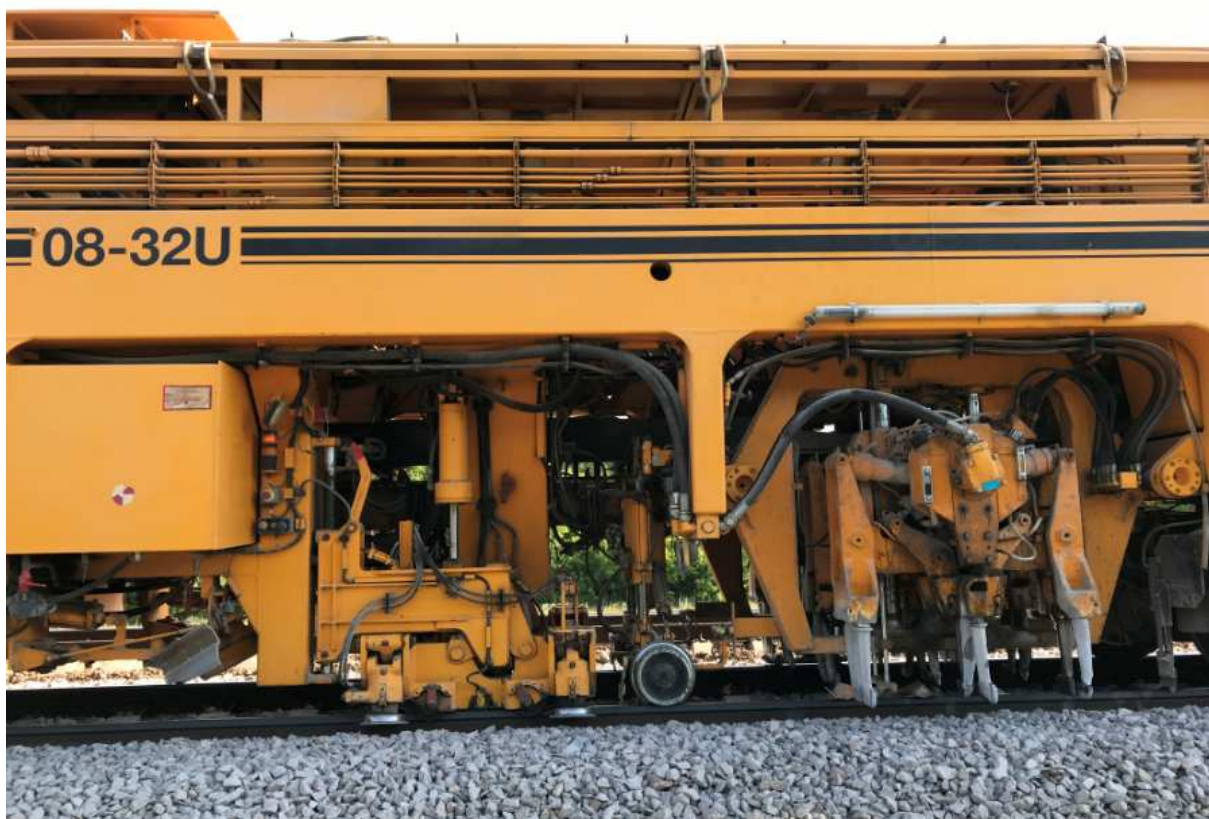
Рисунок 2 - Общий вид выправочно-подбивочно-рихтовочной машины «Duomatic»
