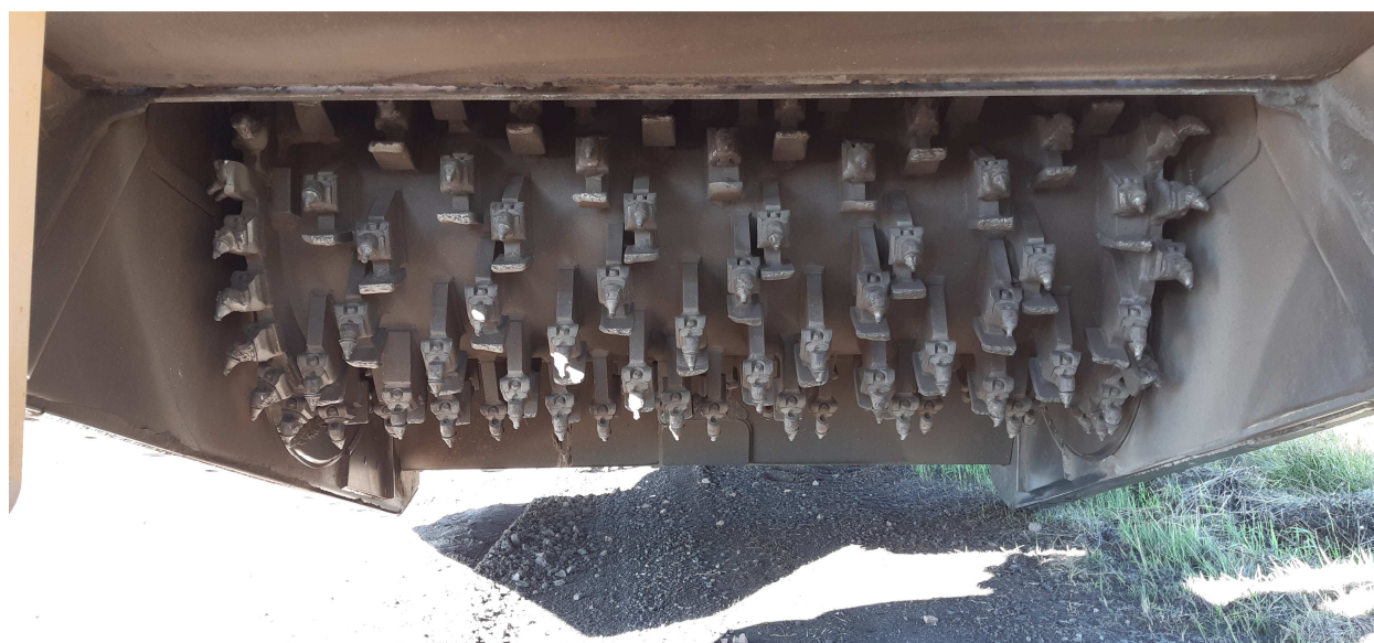
Рисунок 2 – Фрезерно-смешивающий барабан ресайклера
