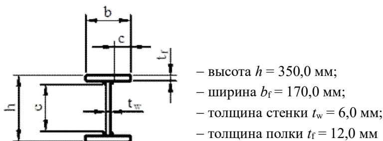
Рисунок В.14 – Размеры сечения двутавровой балки-ригеля первого и второго этажей
