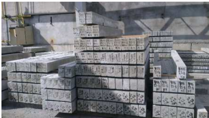
Рисунок 6 - Общий вид складирования железобетонных перемычек
