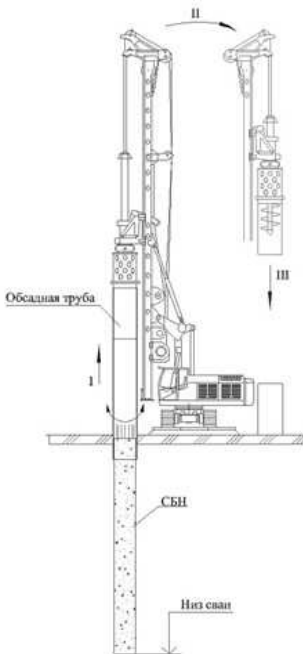
Рисунок 17 - Извлечение обсадной трубы
