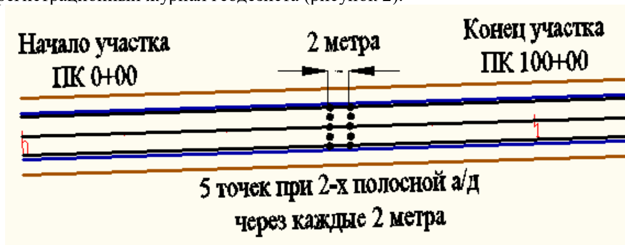
Рисунок 2 – Схема геодезических отметок для определения объема
