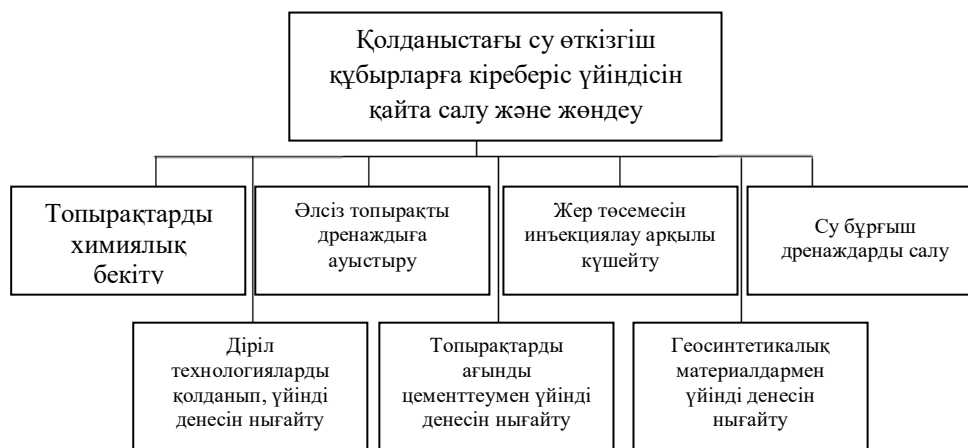
41-сурет – Қолданыстағы су өткізгіш құбырларға кіреберіс үйіндіні жөндеу
