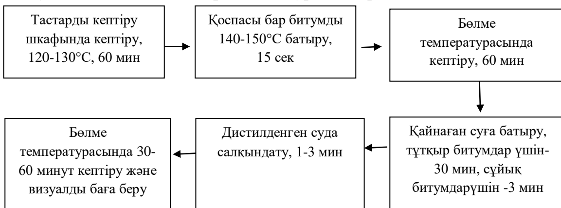
2-сурет – Битумның тас материалмен ілінісуін қайнату әдісімен анықтаудың технологиялық сұлбасы
