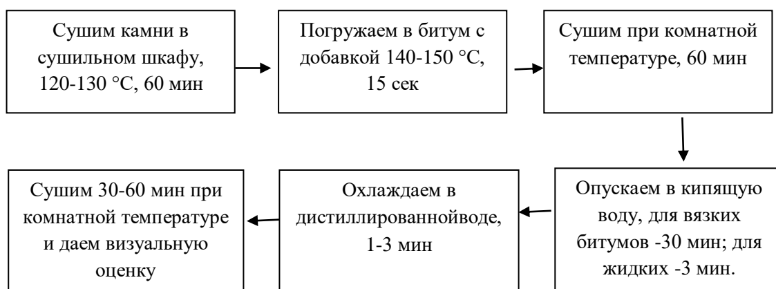
Рисунок 2 – Технологическая схема по определению сцепления битума с каменным материалом методом кипячения
