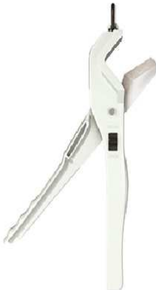
Рисунок 10- Специальные кусачки для резки труб или кольцевой резчик (труборез).
