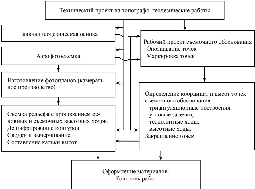
Рис. 2. Технологическая схема полевых работ при комбинированной съёмке
