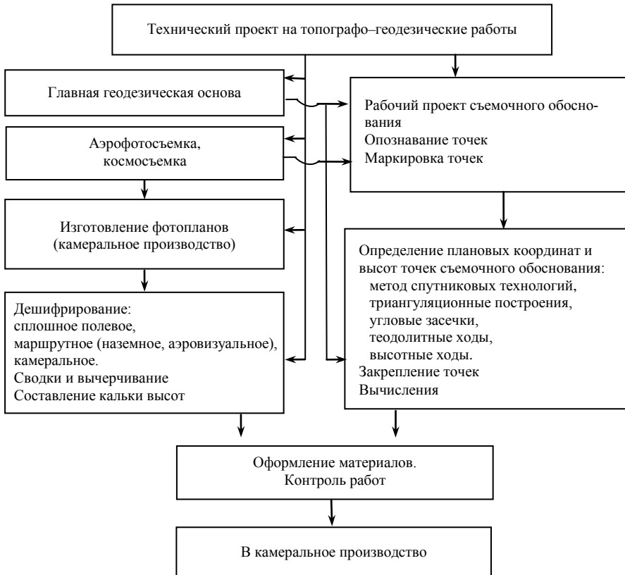
Рис. 1. Технологическая схема полевых работ при стереотопографической съёмке
