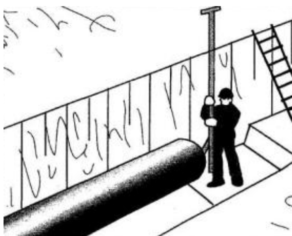
Рисунок 6 – Выверка положения трубы
