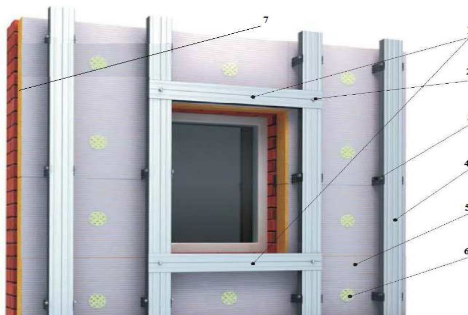
Рисунок 1 – Конструкция навесного фасада с воздушным зазором и облицовкой металлическим сайдингом
