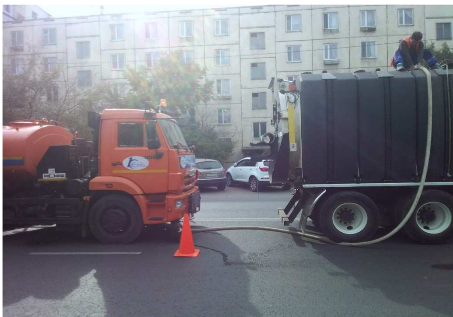
3-сурет – Суару машинасын қолдана отырып гидродинамикалық машинаның цистернасын суға толтыру процесі
