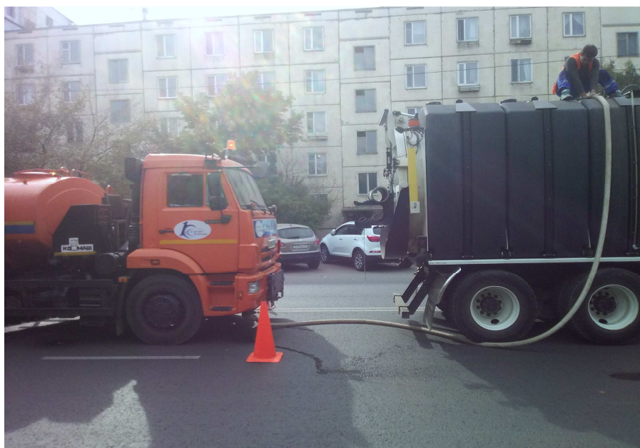
Рисунок 3 – Процесс заполнения водой цистерны гидродинамической машины, с применением поливомоечной машины
