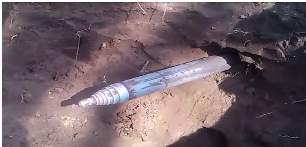
8-сурет – Шұнкырда қойылған пневмотескіш
