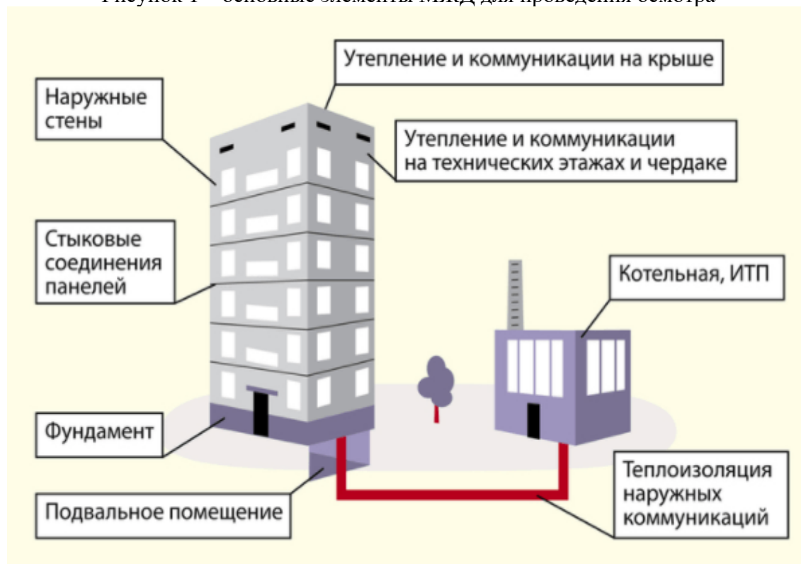
Рисунок 1 – основные элементы МЖД для проведения осмотра
