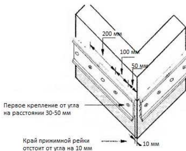
Рисунок 22 - Установка смежных прижимных реек в угловых соединениях
