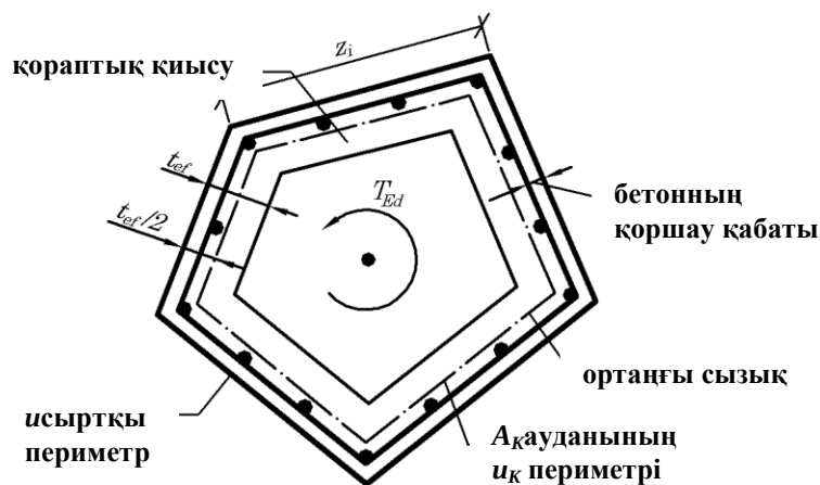
7.9-сурет – Айналдыруға ұшыраған элементтің қиысуының схемасы, қабылданған терминдер мен белгілер
