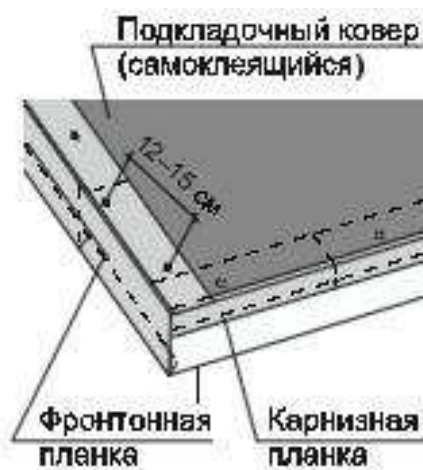
Рисунок 16 – Схема крепления фронтовой планки
