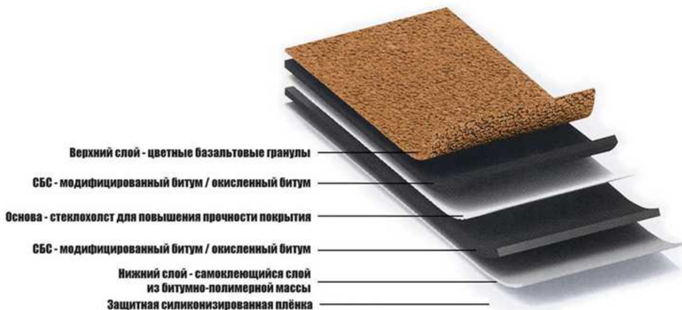
Рисунок 1 - Строение гибкой черепицы
