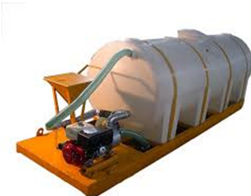
Рисунок 5 - Общий вид установки для приготовления бурового раствора
