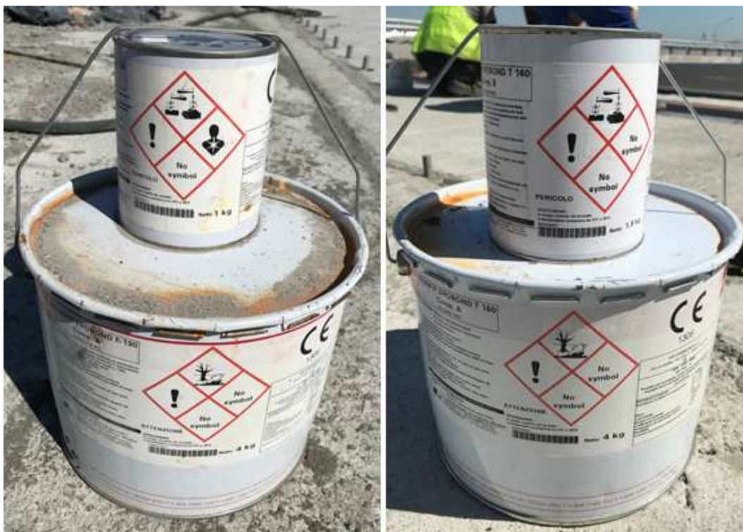
Рисунок 8 - Двухкомпонентные клей-герметики для анкерных шпилек, листов скольжения и водоотводного лотка
