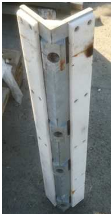
Рисунок 3 - Общий вид блоков скольжения поперечной стальной направляющей с резьбовыми отверстиями для закрепления резинометаллических модулей
