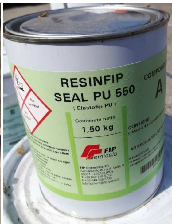
Рисунок 11 - Общий вид гранулированной резины и двухкомпонентного состава для заполнения анкерных колодцев
