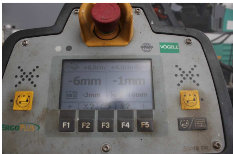
Рисунок 9 – Автоматическая система асфальтоукладчика выдерживания толщины укладываемого асфальтобетона
