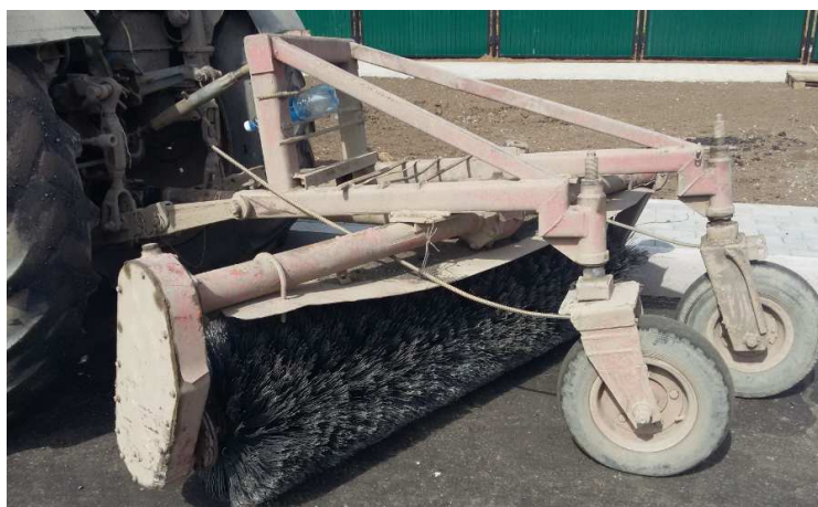
Рисунок 3 - Механизм с щеткой на базе МТЗ-80
