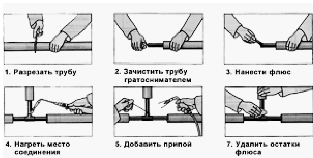
Рисунок 13 – Технологическая последовательность действий при пайке медных труб
