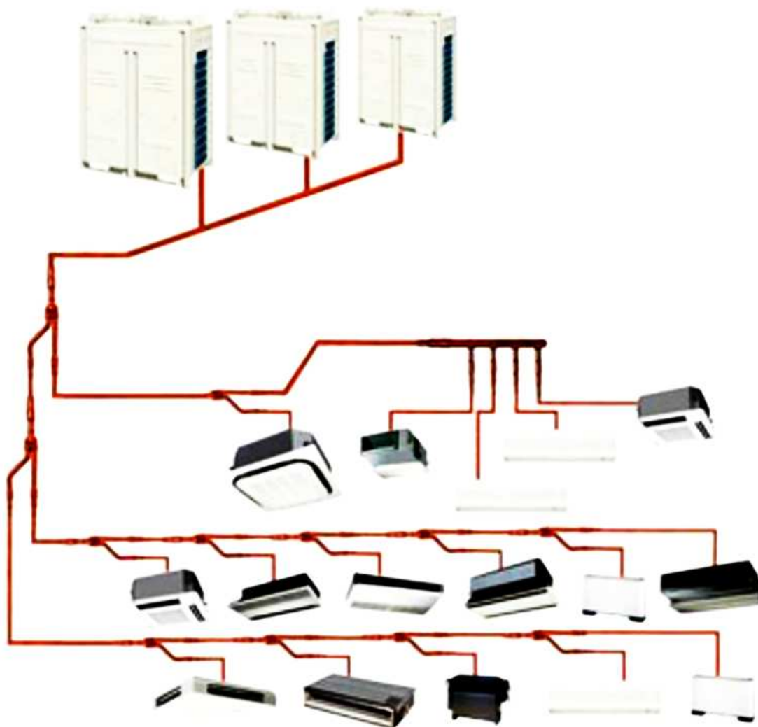
Рисунок 6 - Конструкция соединения рефнетов (разветвителей).
