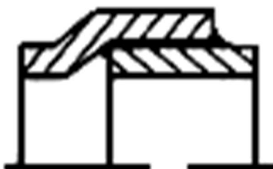
Рисунок 11 - Телескопические паяные соединения ПН-5
