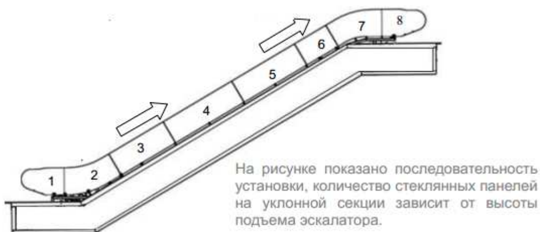
Рисунок 30 – Этап сборки стеклянных панелей
