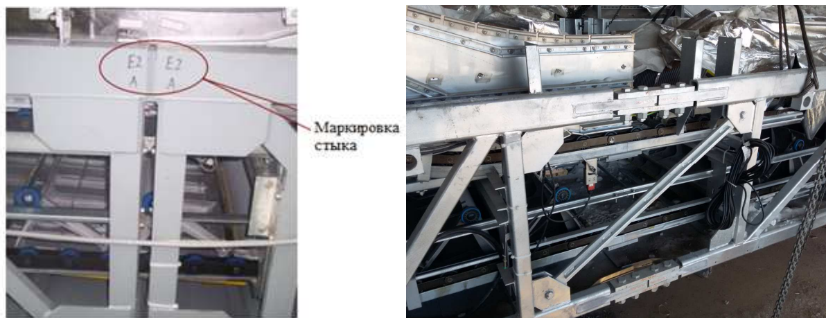
Рисунок 15 – Стык составных частей эскалатора и их маркировка
