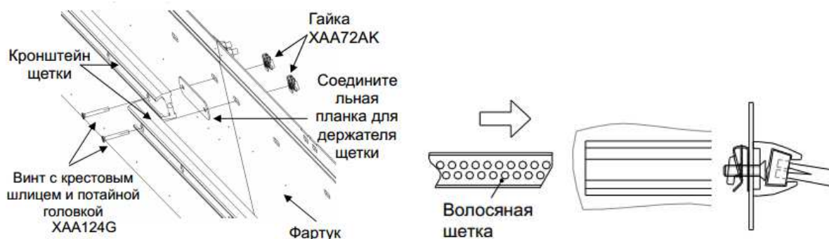
Рисунок 30 – Монтаж кронштейна щетки и установка волосяной щетки в канавку
