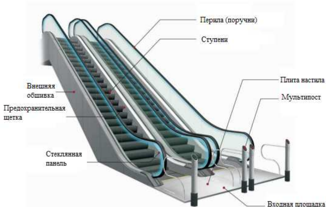
Рисунок 2 – Эскалатор с составными частями по отделке
