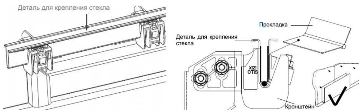
Рисунок 29 – Деталь крепления для стекла и прокладка
