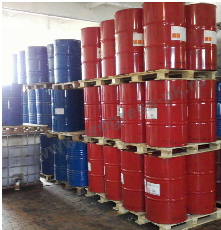
Рисунок 1 – Жидкие компоненты "А" (полиольная смесь) и "Б" (изоцианатная смесь) пенополиуретана в емкостях
