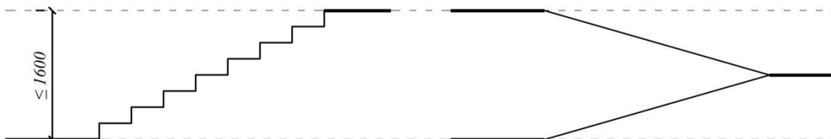
Рисунок И.1 - Варианты устройства пандусов, лестниц
